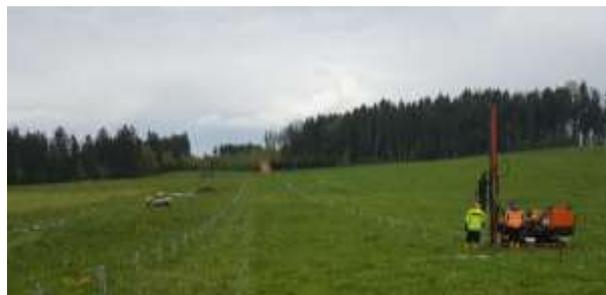
*Abbildung 3: Hydraulikramme auf Ketten*
